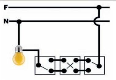
Instalación típica de conmutadas y cruzamiento.
