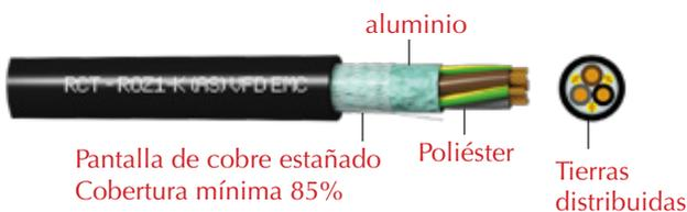
Estos cables por su especial diseño (tierras distribuidas, pantalla combinada con cobertura del 100% para altas frecuencias y 85% para bajas frecuencias) son los más adecuados para la alimentación de variadores. Un variador de frecuencia VFD= Variable Frecuencia Drive es el sistema de control de la velocidad rotacional de un motor de corriente alterna mediante la
